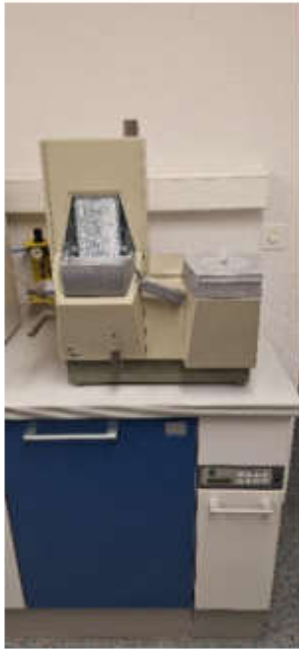
Kavo Bandschleifer mit Fräse
