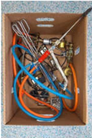
Brennerset von Gloor für Sauerstoff/Propan. Mit Anschlusschlauch, je einem Druckanzeiger/Reduzierventil für Sauerstoff und Propan, Sicherheits Gas Magnetventil, Kronenbrenner, Mikrobrenner mit diversen Einsätzen, Tischhalterung
